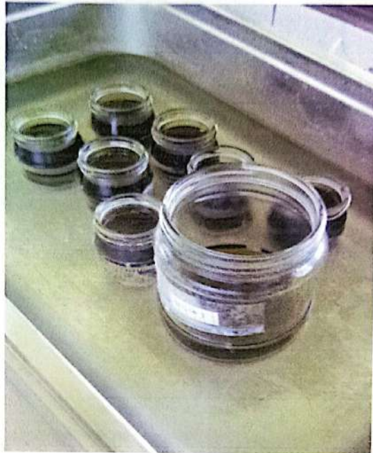
Gambar 9 Proses penguapan ekstrak cair dengan menggunakan water bath
