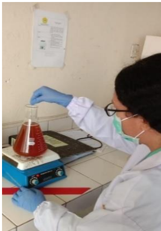
Pemanasan PCA diatas hot plate hingga mendidih.
