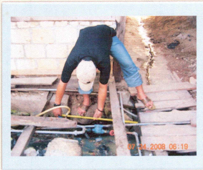
Dokumentasi 4. Pengukuran panjang dan lebar saluran pada industri pembuatan tahu di Distrik Abepura
