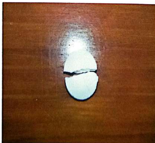
Gambar 10. Tablet klorokuin setelah uji kekerasan
