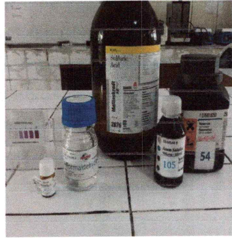
Gambar 13 Reagen yang digunakan dalam pemeriksaan Tesk Kit Formalin, reaksi salisilat dan reaksi cincin
