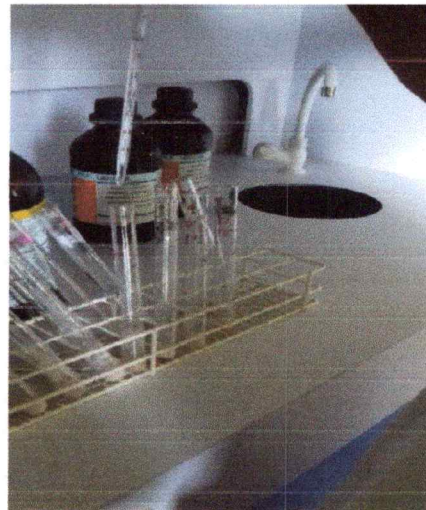
Gambar 10 Proses Penambahan reagen pada sampel yang sudah dilarutkan
