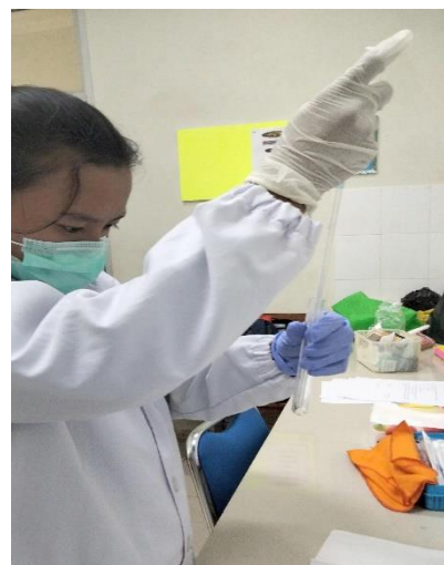
6. Proses pemindahan reagen NaCL 0,9 % kedalam tabung
