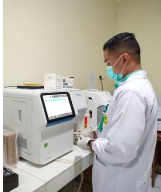
Pemeriksaan Diff (Limfosit) pada alat Hematology Analyzer Sysmex XN 350
