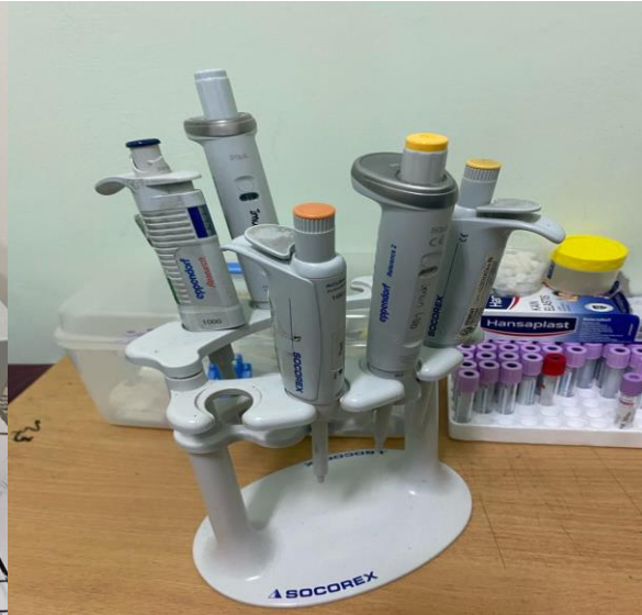
Mikropipet untuk memindahkan larutan atau cairan dari satu tempat ke tempat lainnya
